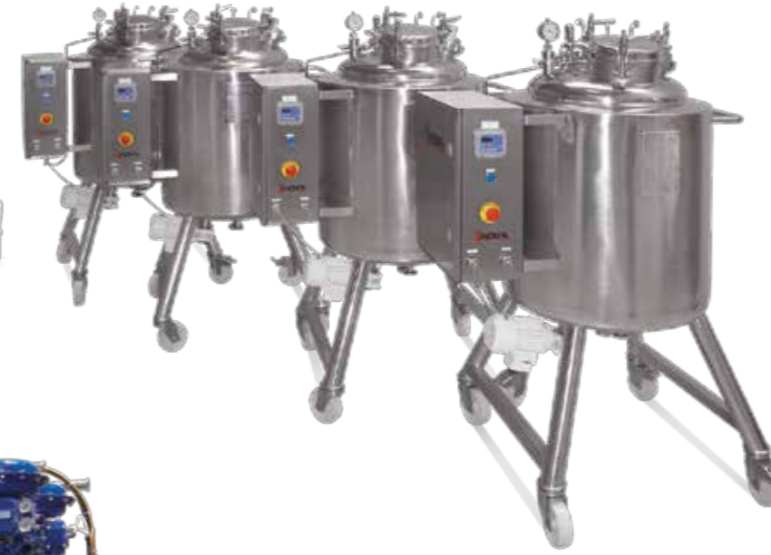
Reactores para preparación de soluciones inyectables. Incluye instrumentación, agitador, cuadro eléctrico y de control y videoregistrador. Reactors for preparation of solutions for injections. Includes: instrumentation, agitator, control panel and video recorder.
